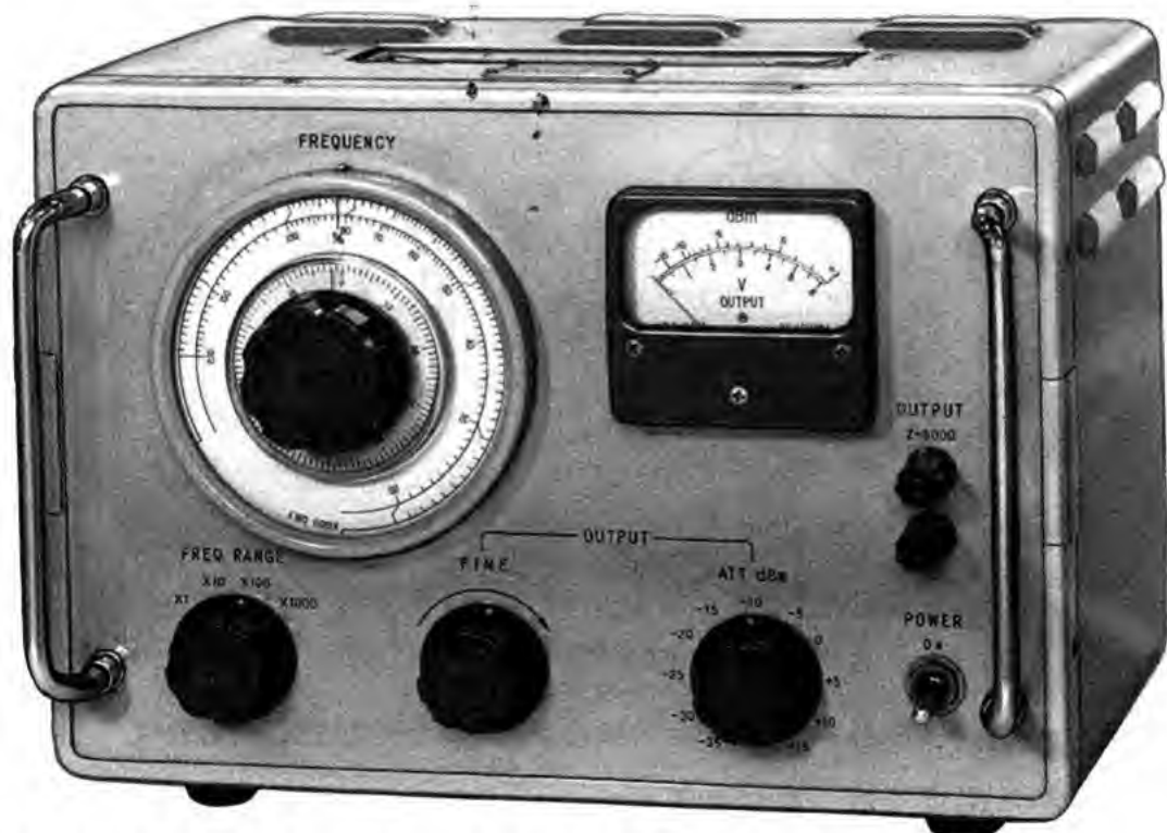
CR発振器の例 回路測定に用いる低周波CR発振器の例で、0.1〔Hz〕から、1〔MHz〕まで周波数を変えることができる。
